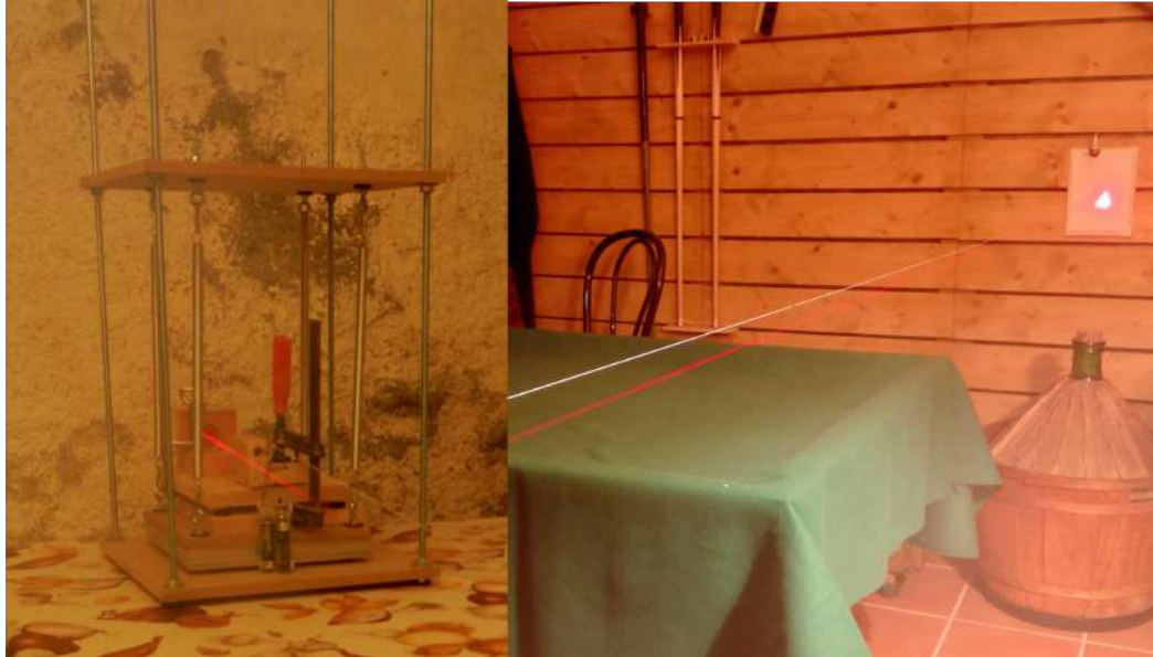
Figura 4: L'utilizzo di vapore permette di fotografare il fascio laser.
