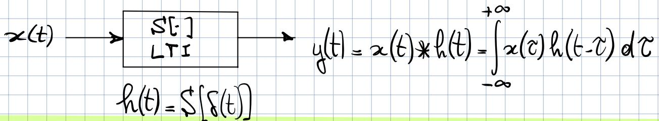
ESEMPIO di CALCOLO delle CONVOLUZIONE:
