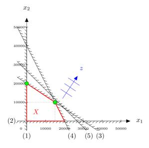
La soluzione ottima fornita dal solutore non è unica: poiché le curve di livello dell'obiettivo sono parallele al vincolo (5), anche la soluzione di base  $x_1=15000,\,x_2=10000$  è ottima. Del fatto che la soluzione ottima non sia unica è facile accorgersi notando che una delle variabili fuori base,  $x_1$ , ha costo ridotto nullo. Si tratta di un esempio nel quale il problema duale è degenere e quindi il primale ha soluzioni ottime multiple.
