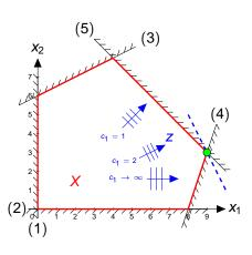
Quando  $c_1$  decresce, la f.o. ruota in senso antiorario, finché la base ottima cambia per  $c_1 = 1$ , quando le linee di livello diventano parallele al vincolo (5).
