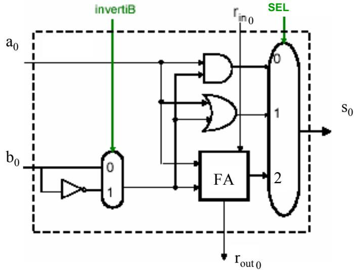
$r_{in}(0) = \text{InvertiB} = 1$  sse sottrazione
