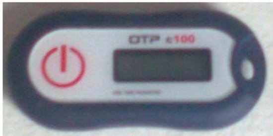
I piú diffusi si basano su **synchronous dynamic password**: la password cambia ad intervalli regolari, per esempio ogni minuto. La sincronia è un fattore critico
