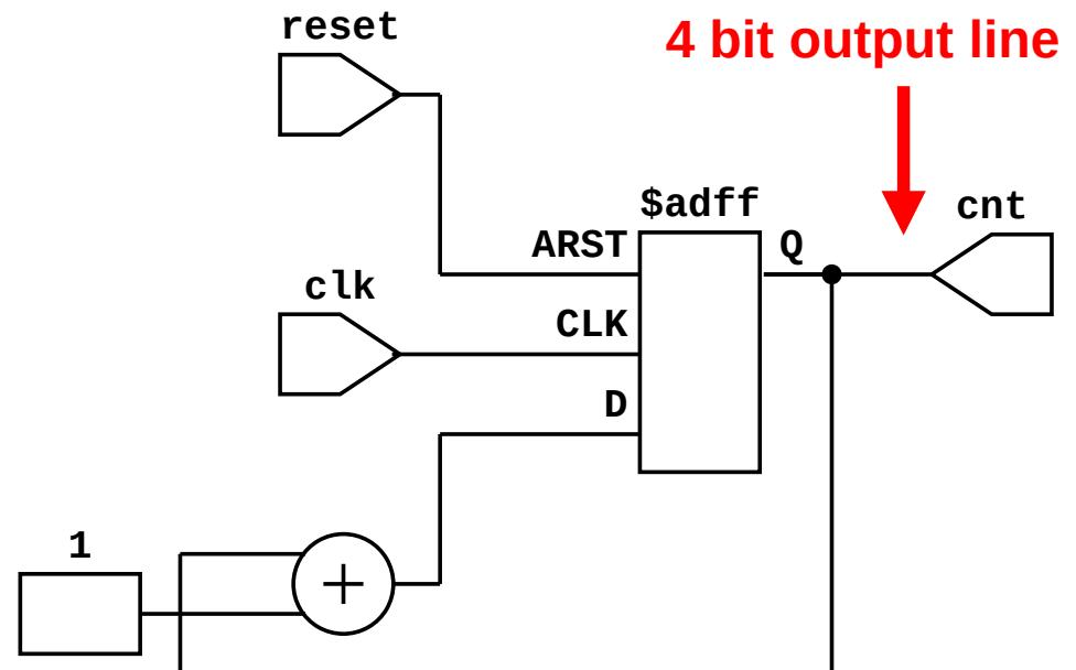
Un assegnamento a segnale **di tipo concorrente** e' utilizzato per aggiornare **continuamente** il valore del segnale in uscita assegnando ad esso il valore di CNT\_tmp .
