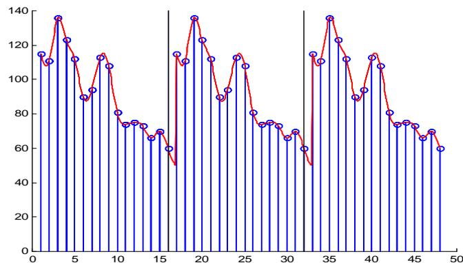
Guardando il segnale su dominio infinito si vedono però delle discontinuità spurie -> alte frequenze -> finestatura per rendere il segnale continuo ai bordi senza alterarne il contenuto in frequenza.
