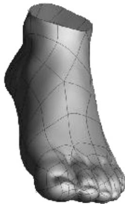
Figura 2.11.: Un reticolo di *patch* B-spline [EH96].
