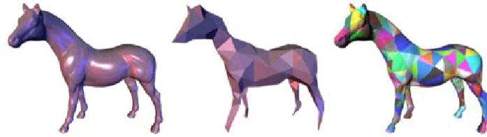
Figura 2.23.: MAPS: il modello a bassa risoluzione è utilizzato come base per la parametrizzazione che poi viene propagata ai vertici del modello originale [LSS<sup>+</sup>98].
