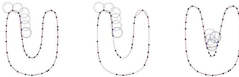
Figura 2.19.: Comportamento di *Ball pivoting* su dati con differenti caratteristiche [BMR<sup>+</sup>99].
