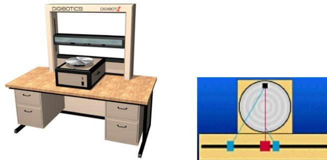
Figura 2.15.: Un modello di scanner Digibotics (sinistra )e la tecnica utilizzata per la misura (destra) [DIGb].
