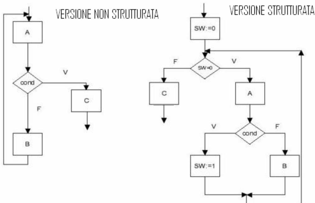
Sulla destra invece è presente uno schema a blocchi che realizza lo stesso algoritmo, ma soddisfa i requisiti della programmazione strutturata. Per realizzarlo si è impiegata una variabile dal nome *SW* inizializzata a zero.
