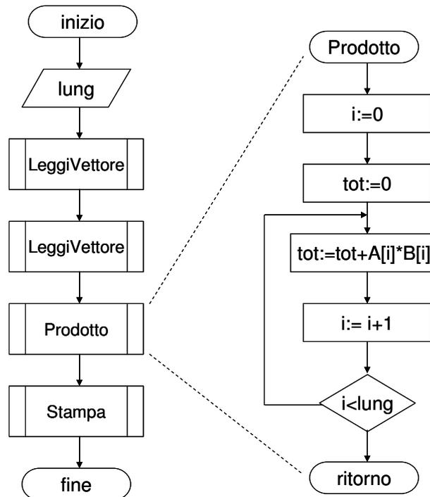
La soluzione proposta mostra la decomposizione del sottoprogramma Prodotto che si occupa di calcolare il prodotto scalare di due vettori. Gli altri sottoprogrammi LeggiVettore e Stampa possono essere sviluppati in modo analogo e per brevità vengono omessi.
