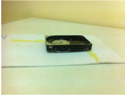
Figura 4.9: Hard Disk utilizzato come piatto rotante
