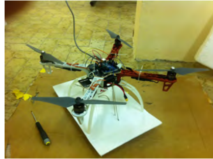
Figura 4.10: Comelicottero montato sul piatto rotante
